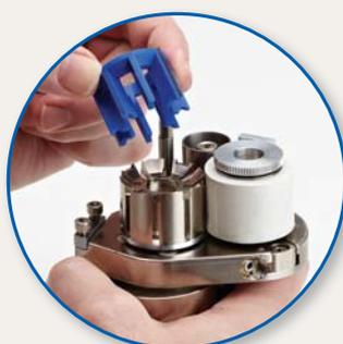
Извлеките картридж с режущим элементом
